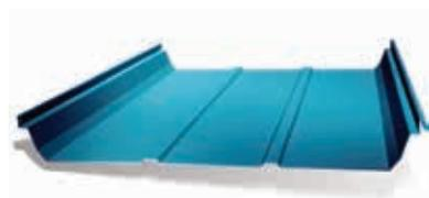
Système de toit à joint debout à montants trapézoïdaux et à assemblage par pression pouvant être installé sur différents types de constructions. Une pince coulissante standard permet la circulation de la chaleur. Ce type de pince est offert en versions longue et courte, qui conviennent à différentes épaisseurs d'isolant en fibre de verre à revêtement de vinyle.
