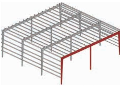
Ossatures à portées multiples, à colonnes coniques, à pente unique
