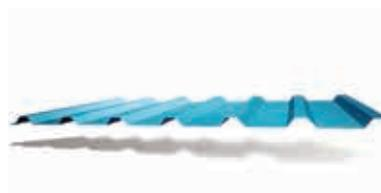
Conçu à la fois pour les applications de toiture et de mur, le panneau PBU peut être installé directement sur des panneaux ou des poutrelles. Polyvalent, il convient à des applications horizontales et verticales, ce qui permet aux concepteurs de donner une facture contemporaine à leur projet de construction. Le panneau PBU est recommandé lorsque les angles de déclivité sont de 1:12 ou supérieurs.
