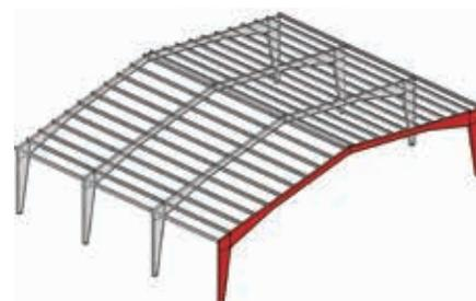
Ossatures à portée libre, à colonnes coniques, à pente double
