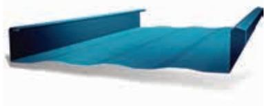
Systeme assemble mecaniquement sur le chantier qui allie une nervure mince de 2 po de hauteur a une resistance au soulèvement exceptionnelle. Le systeme SuperLok<sup>MD</sup> peut etre installe directement sur des pannes ou des poutrelles. Le panneau n'a besoin d'aucune sous-structure solide pour le soutenir. Outre la cote UL 90, le systeme SuperLok<sup>MD</sup> est conforme a plusieurs normes, comme le demontrent les tests menes selon la norme 4471 de FM Global Corporation.
