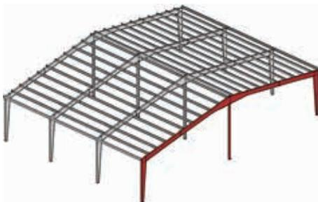
Ossatures à portées multiples, à colonnes coniques, à pente double
